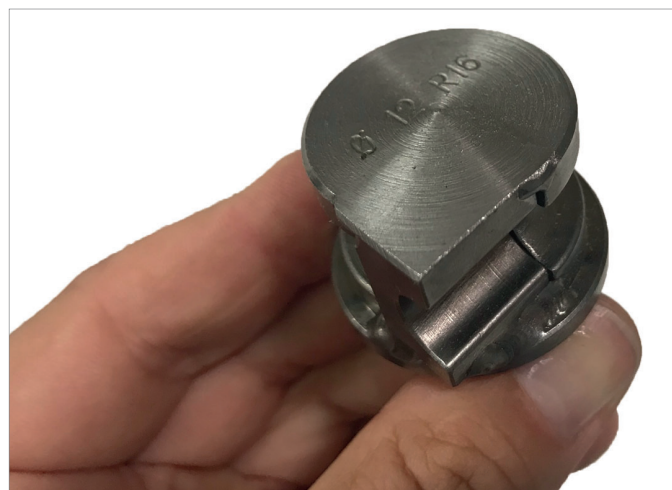
Biegewerkzeug mit Spannfläche
